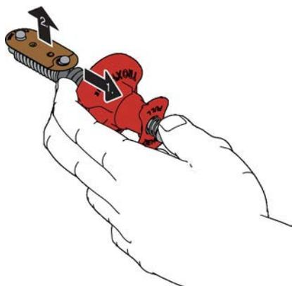
Fig. 131: Sostituire il fusibile
