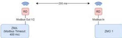
Fig. 24: X-AIRCONTROL con un collegamento mesh
