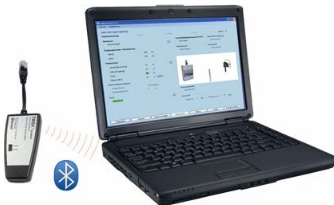
Fig. 30 : Paramétrage du raccordement à l'aide d'un adaptateur Bluetooth BlueCON
