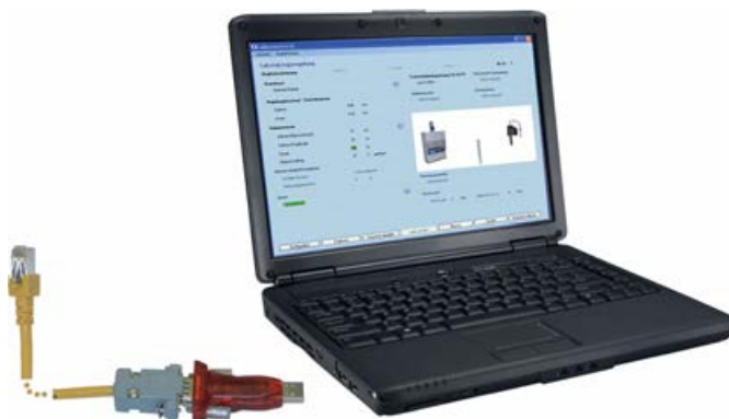
Fig. 29 : Configuration du raccordement à l'aide du câble de configuration EASYLAB
