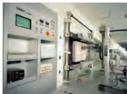
Banc d'essai EN 1822-4
