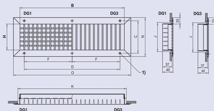
1) Trous de fixation noyés  $\varnothing 4.8 \times 90^\circ$
