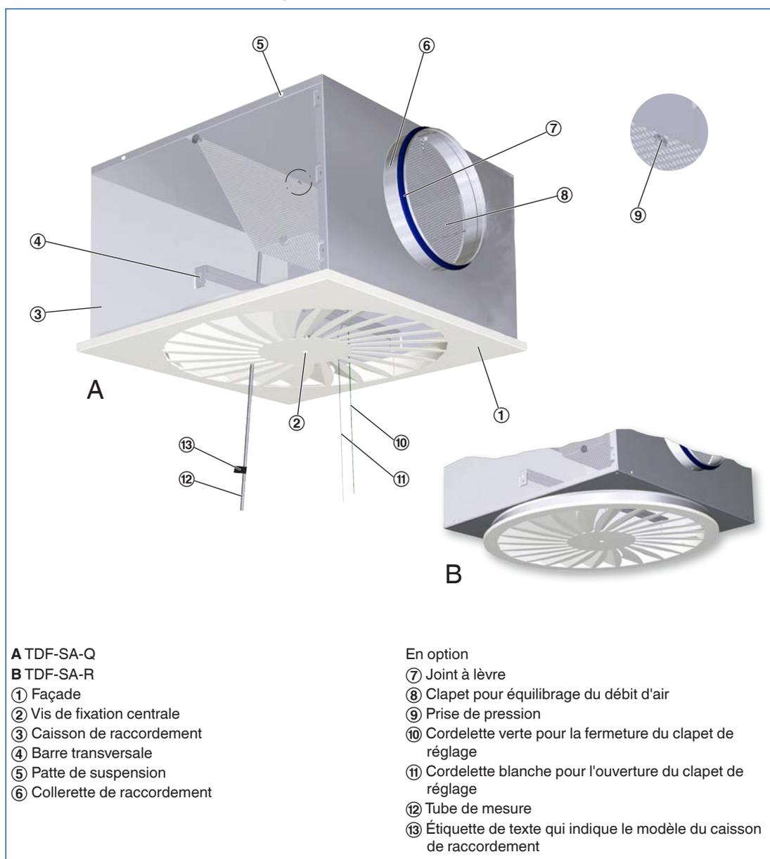
Soufflage horizontal omnidirectionnel
