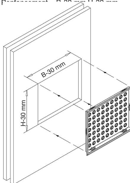
3 Fixation de la plaque de buse à l'aide des vis. Les vis de montage ne sont pas fournies. Les trous de vis disponibles ont un Ø de 6 mm.
