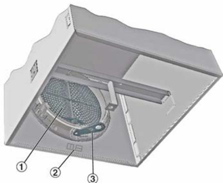
Fig. 23 : Clapet fermé (90°, uniquement avec plénum de raccordement)
