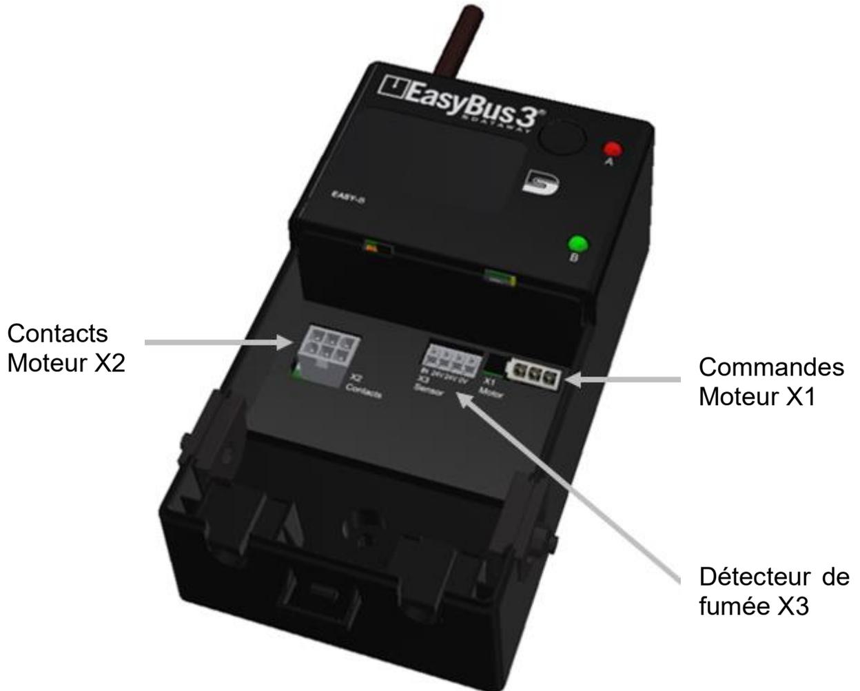
Les connecteurs de commande et de contact moteur sont compatibles avec des connecteurs de type Mate-N-Lok.
