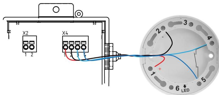
An den Klemmen X4: 3/4 kann, an Stelle eines Rauchmelders, ein beliebiger potentialfreier Steuerkontakt angeschlossen werden (z.B. Brandmeldeanlage). Wenn der Kontakt öffnet, fährt die Klappe in die Sicherheitsstellung. Bei Auslieferung ist die Brücke zwischen X4:3/4 vorhanden.
