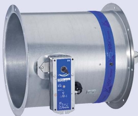
En cas d'incendie, les clapets coupe-feu se ferment automatiquement pour empêcher la propagation du feu et de la fumée dans les gaines vers d'autres compartiments d'incendie adjacents. Les clapets coupe-feu de type FKR-EU sont testés d'après la norme EN 1366-2 et sont conformes à la norme EN 15650.
