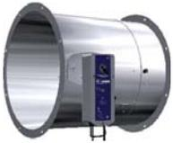
Le fonctionnement du clapet coupe-feu avec un servomoteur à ressort de rappel permet la commande à distance et/ou le déclenchement par un détecteur de fumée adapté. Si l'alimentation est coupée ou s'il y a déclenchement thermoélectrique, le clapet se ferme (alimentation coupée pour fermer). Il est possible de vérifier le fonctionnement des clapets coupe-feu avec servomoteurs à ressort de rappel (OUVERT/FERMÉ/OUVERT).
