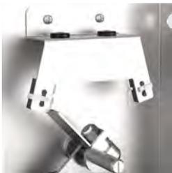
Interrupteurs de fin de course sur les volets de dosage avec servomoteur pneumatique
