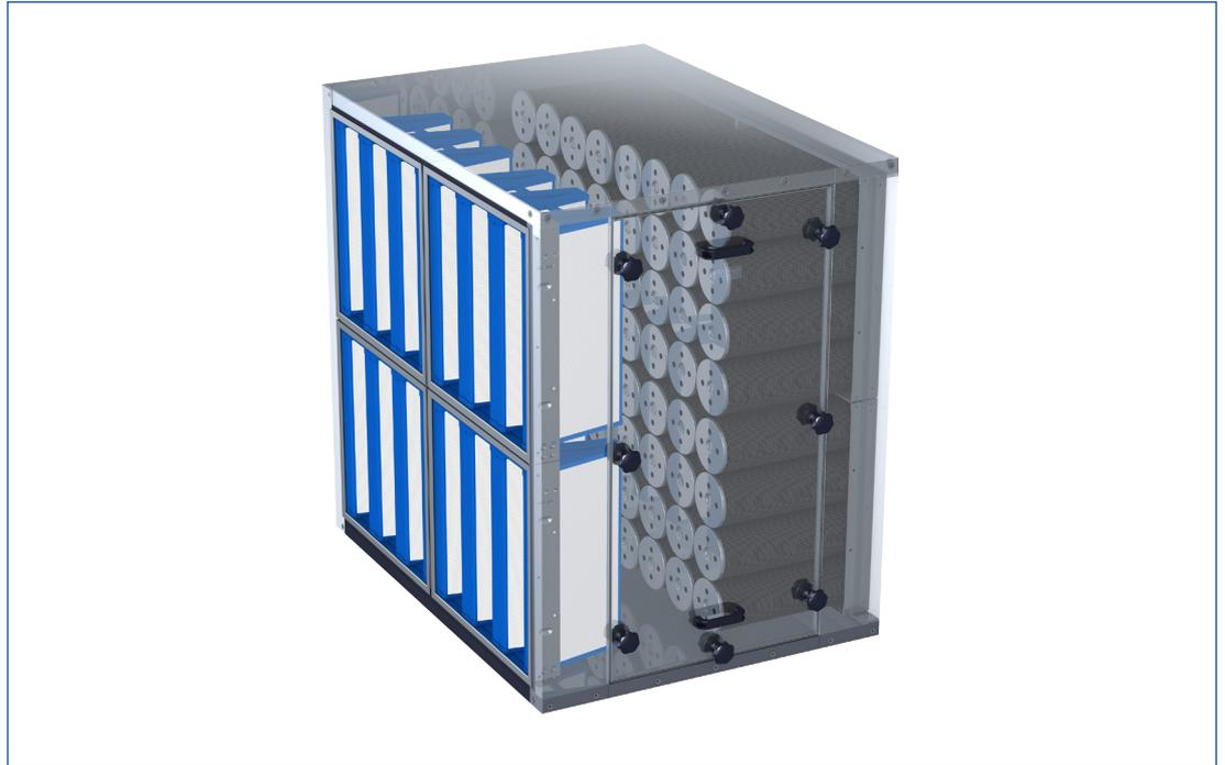
Exemple de variante UCA-2SAF, avec des filtres plissés comme premier niveau de filtration et cartouches à charbon actif comme deuxième niveau de filtration, par exemple des filtres F7 comme préfiltre pour protéger les cartouches à charbon actif pour l'absorption de substances gazeuses.
