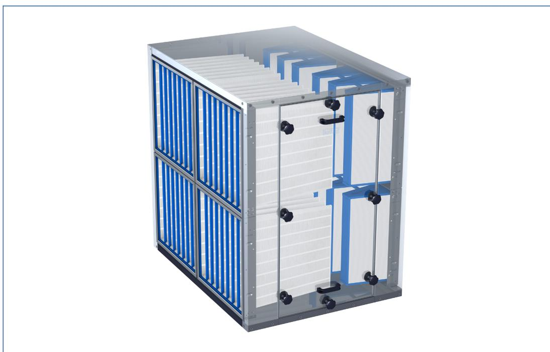
Exemple de variante UCA-2SPF, avec des filtres à poches comme premier niveau de filtration et des filtres plissés comme deuxième niveau de filtration, par exemple des filtres M5 comme filtres primaires et des filtres F9 comme filtres finaux.
