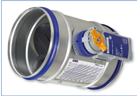
Drosselklappe Variante VFR, mit Stellantrieb (mechanische Anschläge)
